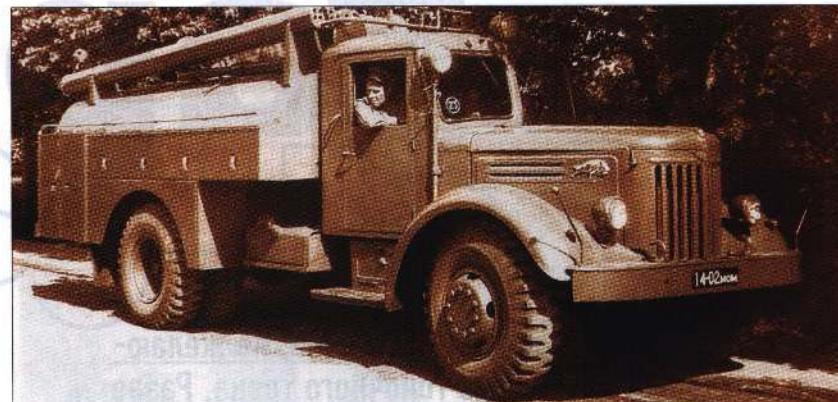
1. Пожарные автоцистерны АЦ-30 (205) модели «Ц» строились на шасси автосамосвала МАЗ-205 с 1962 по 1966 г. Торжокским заводом противопожарного оборудования. Фото автора
